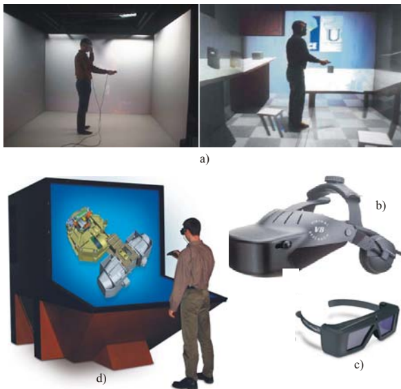
Slika 4. Uređaji za prikaz virtualnog okruženja: a) CAVE, b) HMD, c) stereoskopske naočare, d) Virtualni sto
