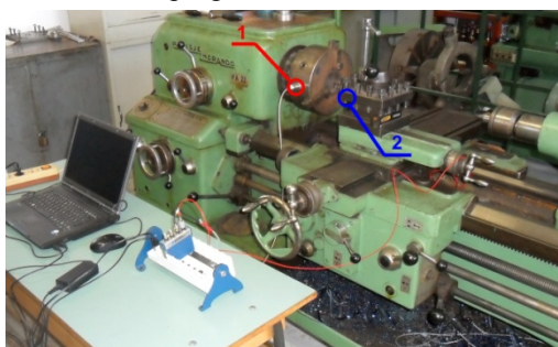
Slika 16. Položaj akcelerometara pri eksperimentalnom ispitivanju
