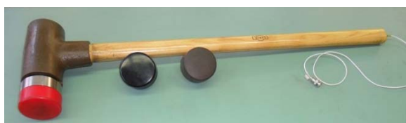
Slika 17. Čekić za ispitivanje impulsnom pobudom PCB Piezotronics model 086D50
